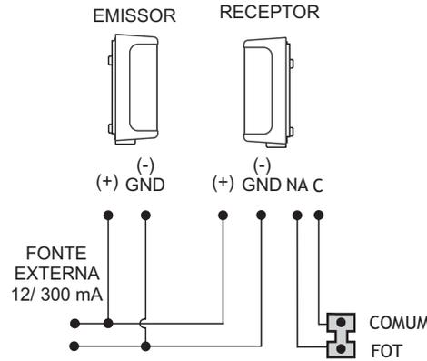
INSTALANDO SENSORES DE ANTI-ESMAGAMENTO (FOTOCÉLULA) NA LINHA DE CENTRAIS BLUE UTILIZANDO FONTE EXTERNA E CONECTOR FOT
